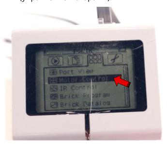
2. С помощью кнопок модуля (верхняя и нижняя или левая и правая) можно включить мотор на 100% мощность. Стрелки указывают, какие кнопки управляют каким портом. Центральная кнопка переключает порты AD и BC.
